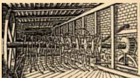
Рис. 50. Многоцеповая немецкая молотилка с приводом от водяного колеса, XVII в. [25]
